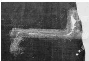
A szakadás poliészter szövettel való megerősítése a hátoldalról
