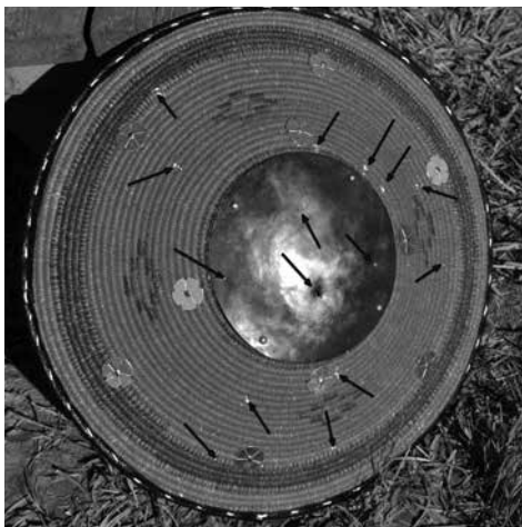
8. kép: A pajzs a teszt befejezése után, bejelölve rajta a nyomot hagyó találatok helyei (fotó: Szöllősy Gábor). A felvétel az utolsó három találat előtt készült, azok nyoma nem látható rajta.
