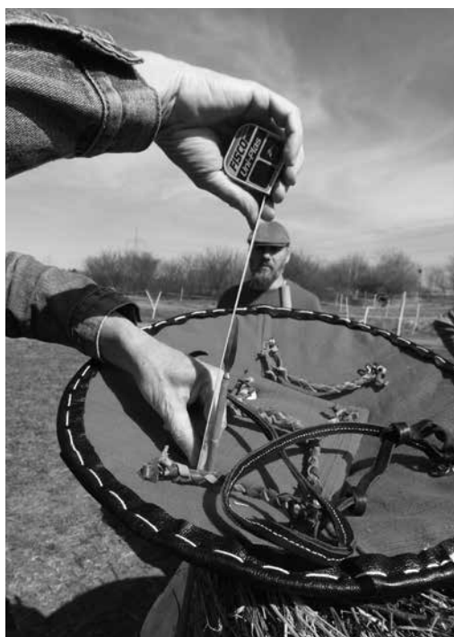
5. kép: Az első találat áthatolásának mérése (fotó: Kőmíves Nelli)
