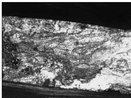
11. ábra. A repesz töretfelülete 8x-os nagyításban a külső felülethez közel
